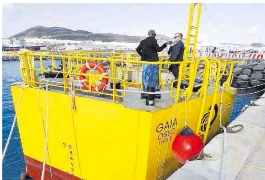
Desalinizadora flotante movida por la energía de las olas en un puerto de Canarias.
